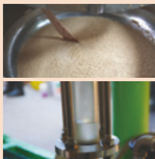
米に麹や酵母を入れて発酵させ、蒸留を繰り返してエタノールを精製する。同社のエタノールはほのかにお米の香りがする
